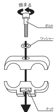
上の図のように 基盤にパイプ支柱を設置し、クランクで固定します。
