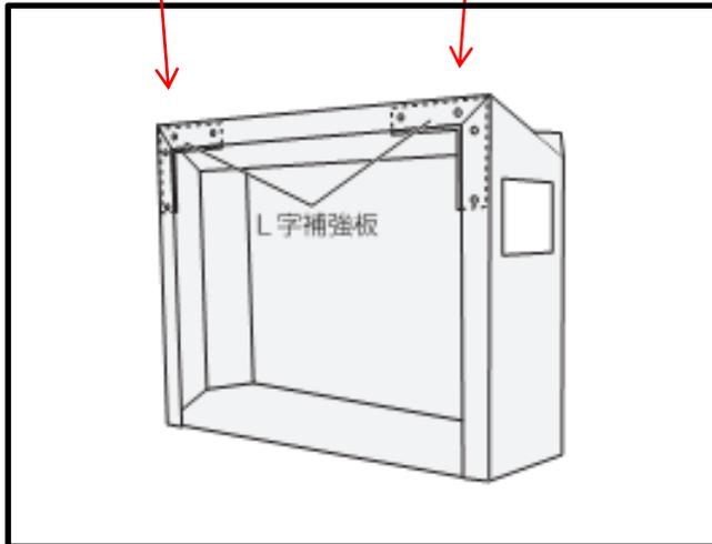
面材の無いオープンタイプの際は、上部左右のコーナーにL字補強板(オプション)で補強します
